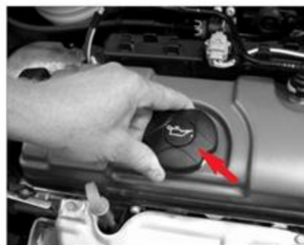
Víčko nalévacího otvoru pro doplnění motorového oleje bývá označeno symbolem olejníčky
