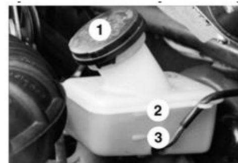
Vyrovnávací nádobka brzdové kapaliny: 1 – víčko uzavírající nalévací otvor pro dolévání brzdové kapaliny; 2 – značka maximální výšky hladiny brzdové kapaliny; 3 – značka minimální výšky hladiny brzdové kapaliny
