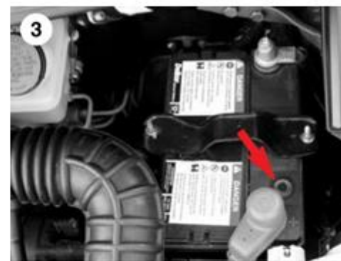
Tři typy akumulátorů: 1 – plně údržbový akumulátor se šroubovacími víčky; 2 – akumulátor s prodlouženým cyklem údržby, víčka jsou pouze nasazena a je nutné je vypáčit; 3 – plně bezúdržbový akumulátor, bez nalévacích víček; 4 – kontrolní okénko informující o stavu nabití
