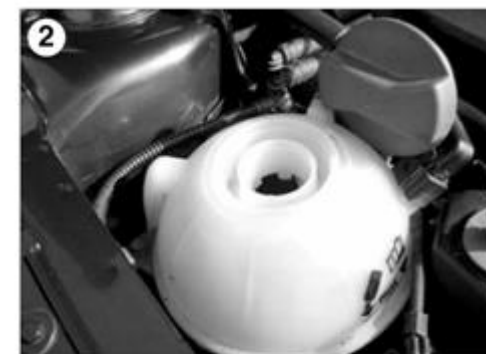
Dva typy expanzních nádobek chlazení. Víčko expanzní nádoby neotvírejte krátce po jízdě, nechte kapalinu vychladnout, hrozí popálení. Při dolévání použijte předem připravenou směs nemrznoucí kapaliny a destilované vody ve správném poměru.
