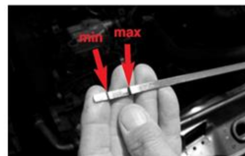
Ryska vyznačující minimální (min) a maximální (max) výšku hladiny oleje
