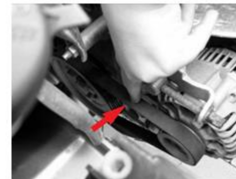
Kontrola napnutí klínového řemene (v místě označeném šipkou) a šroub, po jehož uvolnění lze průhyb řemene seřídit
