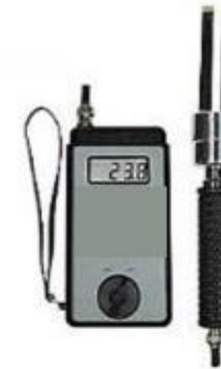
Feuchtemessgerät Aqua-Boy (mit Einstechelektroden und Einschlaggewicht) Quelle: http://www.pce-instruments.com
