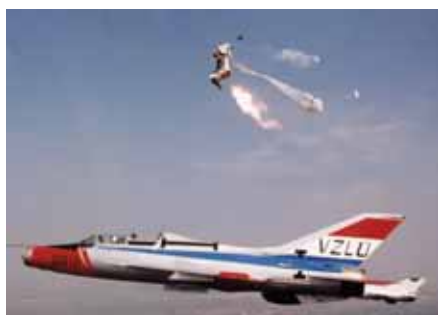
Zkušební katapultáže z MiG-21U (nahore) a pozemní z L-59
