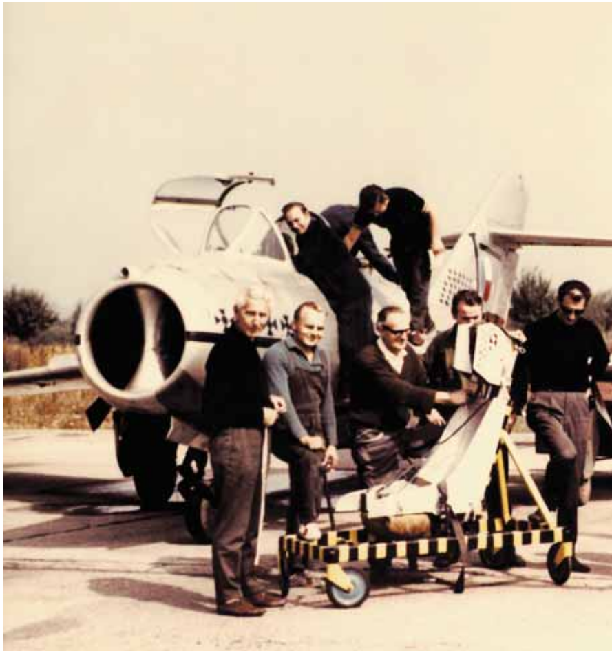
"Létající laboratoř" MiG-15UTI s vystřelovací sedačkou VS-1 pro letouny řady L-39 a její konstrukční tým
