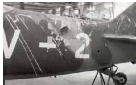
Detail rozlepené překlíčky trupu: Lavochkin La-7, V-2
